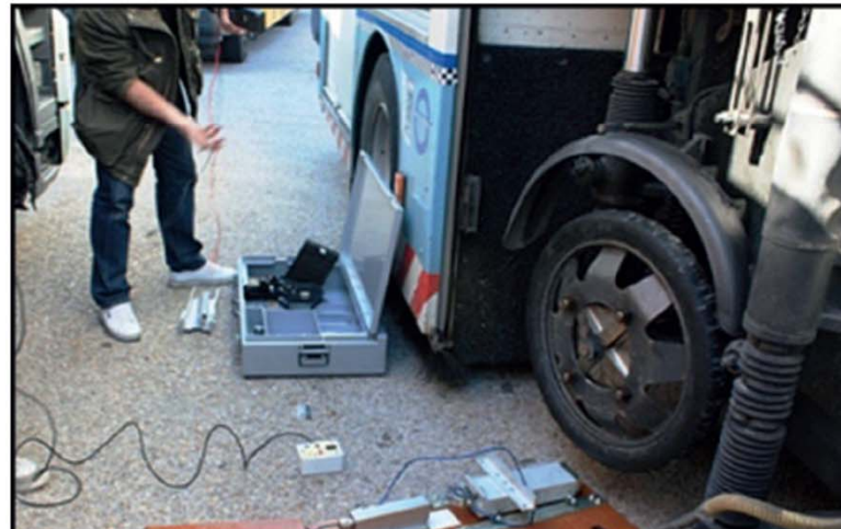
Comprobación de la célula de carga.
